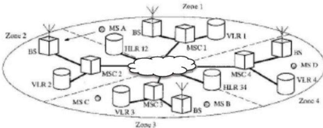
L'identifiant du réseau (Network ID) est 171. Zones 1 et 2 utilisent HLR<sub>12</sub>. Zones 3 et 4 utilisent HLR<sub>34</sub>. La zone nominale et le numéro d'abonné de chaque mobile sont les suivants:
